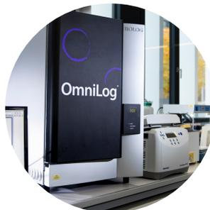
Bis zu 50 Platten werden im OmniLog inkubiert, alle 15 Minuten automatisch ausgelesen und mit der Datenbank abgeglichen.
